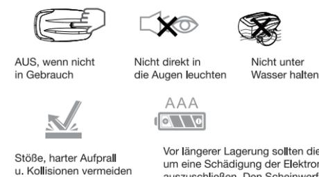
Vor längerer Lagerung sollten die Batterien entnommen werden, um eine Schädigung der Elektronik oder das Auslaufen der Batterien auszuschließen. Den Scheinwerfer kühl und trocken lagern
